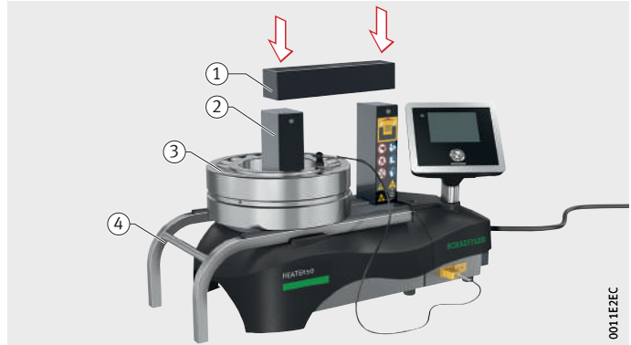
Figura 38 Cuscinetto volvente in posizione orizzontale, listello orizzontale
