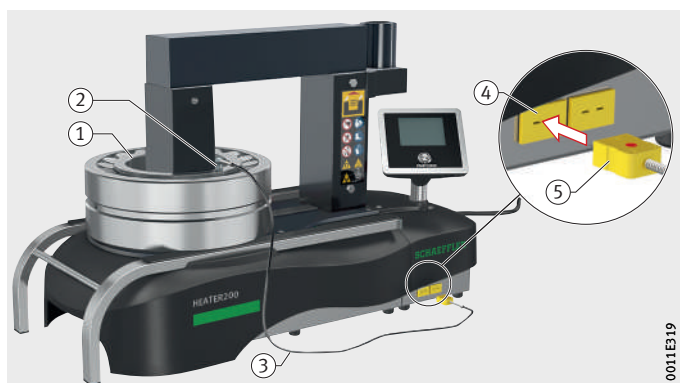
Figura 41 Collegare ed applicare il sensore termico
