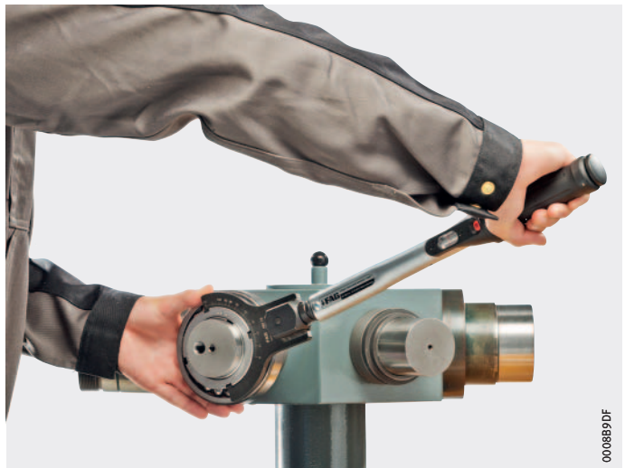
Figura 11 Montaggio mediante chiave a doppio gancio
