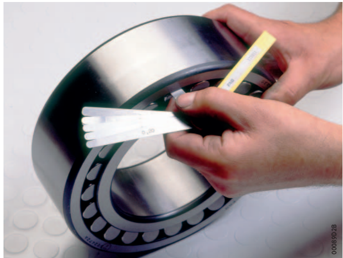
Figura 7 Misurazione del gioco radiale con spessimetro
