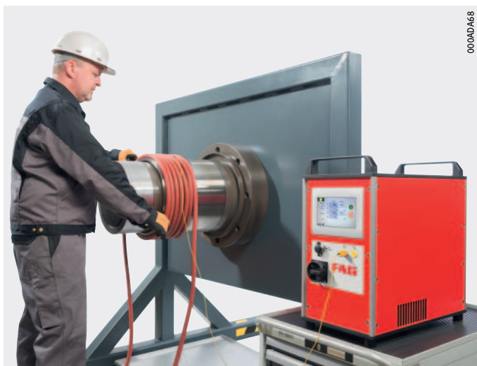
Figura 5 Smontaggio di anelli interni di cuscinetti con induttore flessibile
